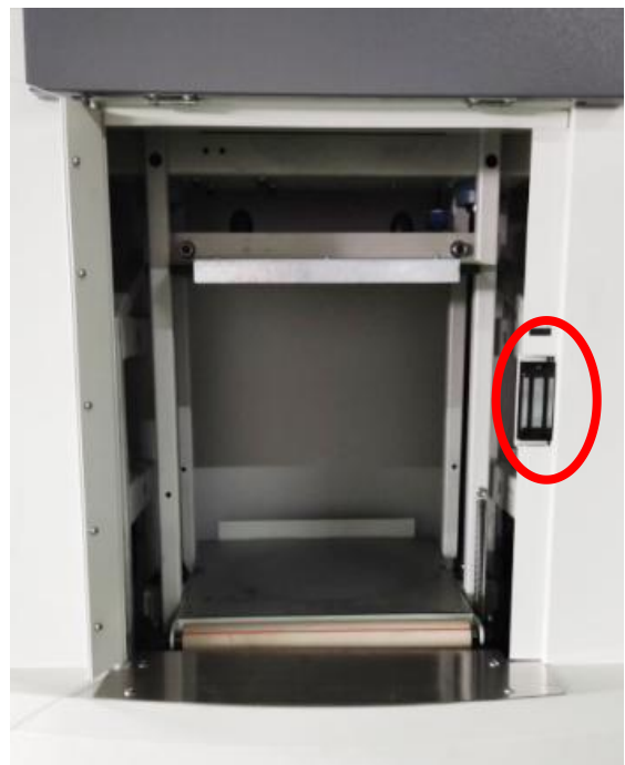
安全电磁门锁，振动时门不能打开。
