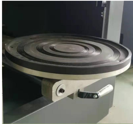
可前移的下夹盘 使装卸包装桶变得轻松方便
